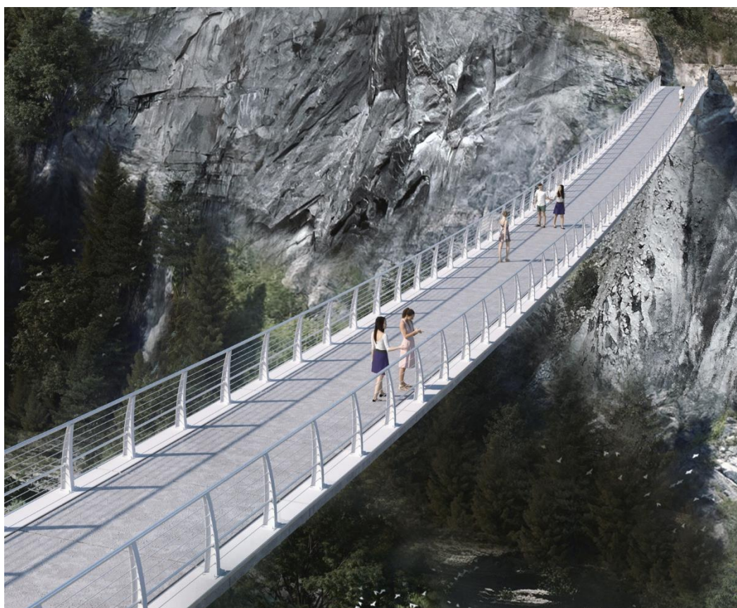
Izvođenje rešenjem prednapregnutih traka („stress ribbon“)
